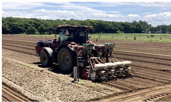
自動操舵トラクターによる播種作業
