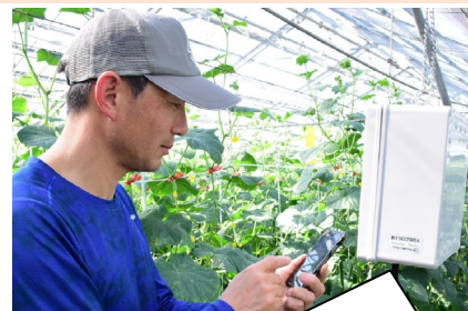
あぐりログ 温度・湿度、CO2濃度等のセンサーのほか、通信機能を搭載
